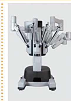
ロボットアーム部(ペイシェントカート): 先端に手術器具の鉗子やメスなどが付いています。4本のアームで構成。
