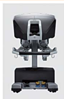
操作部(サージョンコンソール): 執刀医がここでロボットアームを操作して手術します。
